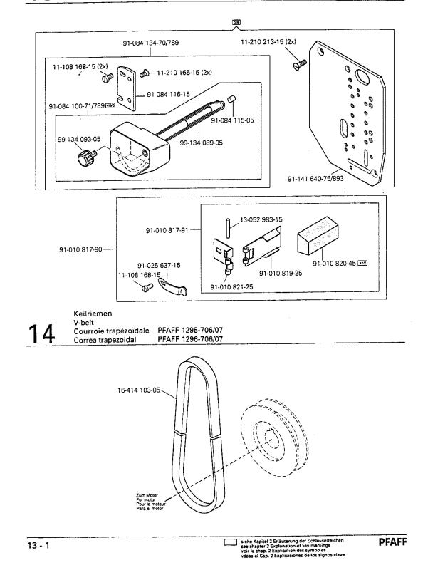
Keilriemenschutz (unter der Tischplatte) Belt guard (under table top) Garde-courroie (sous le plateau de table) Guardacorreas (parte inferior)
